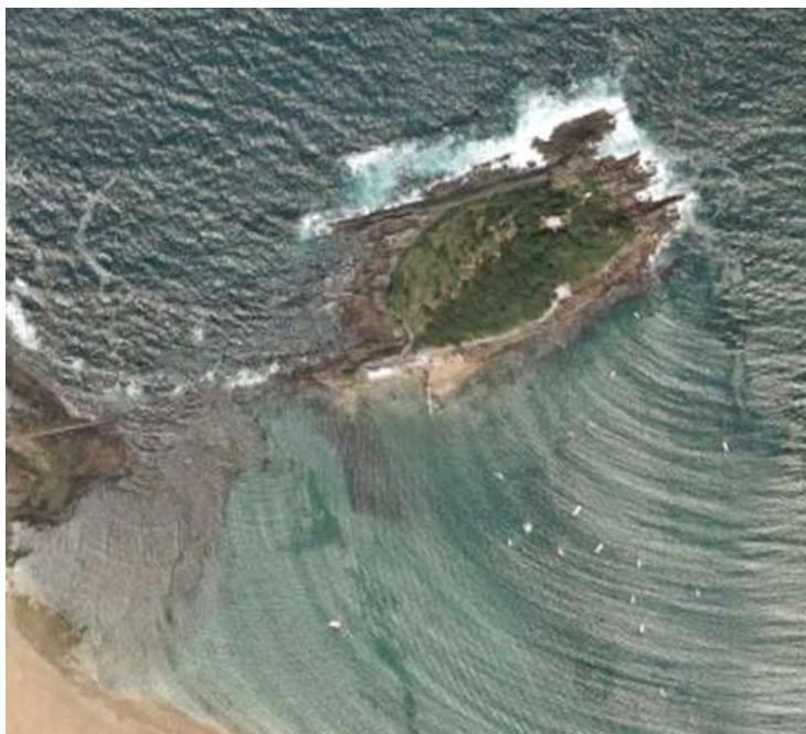
Ce phénomène se produit au voisinage d'obstacles, à l'extrémité d'une digue par exemple. La direction et l'amplitude de l'onde sont modifiées. Elle intervient lorsque la hauteur de houle n'est pas constante sur une ligne de sommet de vague. Sur le schéma, les lignes de crêtes diffractées forment des cercles concentriques.
