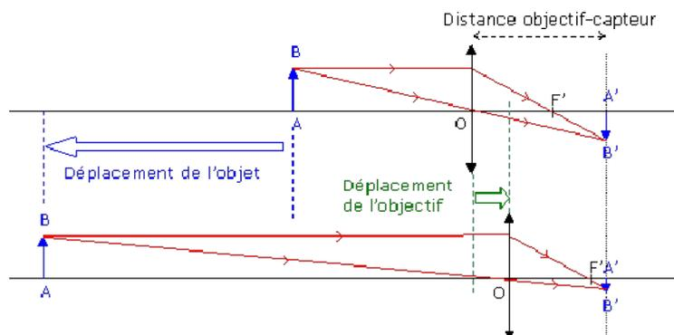
Pour que l'image reste sur le capteur, l'objectif se déplace ce qui modifie la distance lentille image  $OA'$
