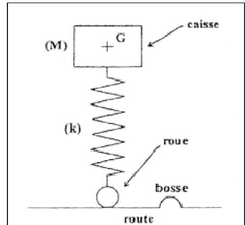
1. On considère la caisse de la Logan de masse  $M = 1\,095\text{ kg}$  à l'arrêt, sans passager. Le ressort est alors comprimé. On appelle  $|\Delta \ell_0|$  la valeur absolue de la différence entre sa longueur à vide et sa longueur en charge.
