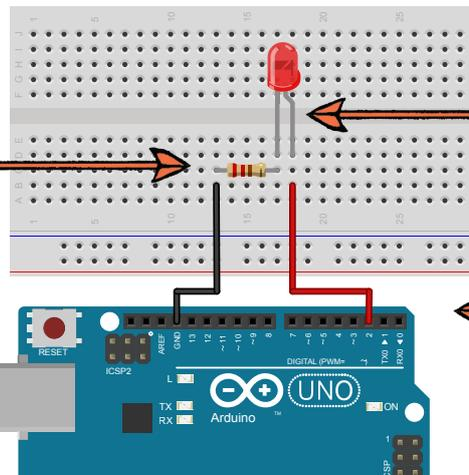
Attention au sens pour brancher la LED : le fil le plus long est connecté avec le fil rouge (vers la tension +5 V).
