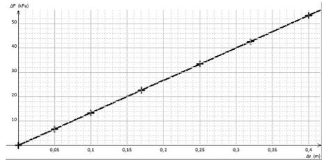
2. a. le graphique représentant l'évolution de  $\Delta P$  (en Pa) en fonction de  $\Delta z$  (en m) est celui d'une fonction linéaire. La différence de pression  $\Delta P$  entre deux points du liquide est donc proportionnelle à la différence d'altitude  $\Delta z$  entre ces deux points.
