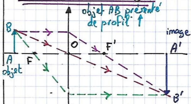
A'B' image réelle: à droite de O (image de webcam)
