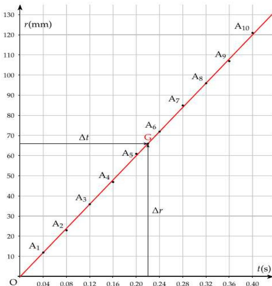
Les points sont quasi alignés, ce qui prouve que la vitesse de l'onde est constante. Pour trouver la droite qui passe au plus près des points, on peut, par exemple, déterminer le point moyen G (moyenne des coordonnées des 10 points). La célérité  $c$  est alors le coefficient directeur de la droite (OG).
